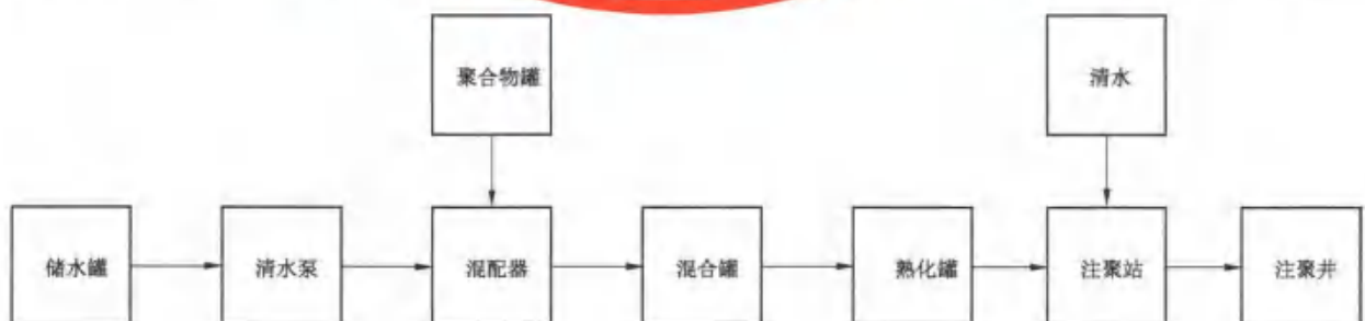
图 A.5 注聚系统典型工艺流程
